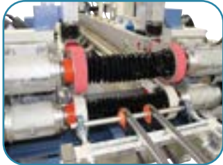
Gruppo pressore a cinghie sincronizzate Roller unit with synchronized belts Grupo presor con correas sincronizadas Unité de pression avec courroies synchronisées
